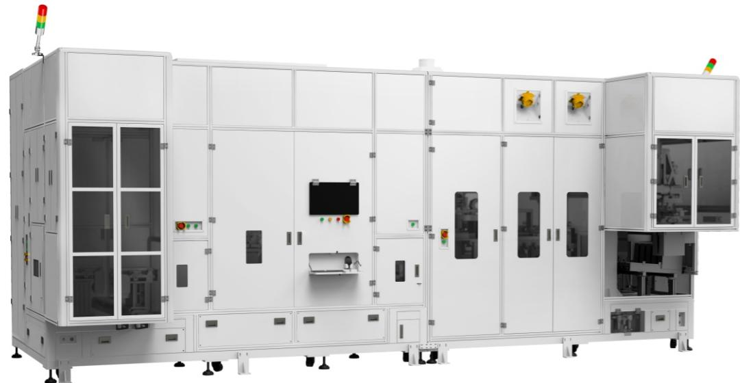
设备用于动力电池的顶盖与壳体之间的激光焊接，实现顶盖与壳体之间的密封性，主要功能包括：电池扫码、电池入夹具定位、激光离焦量检测及焊接、焊接质量检测、翻边辊压、HIPOT测试、焊接飞溅物及烟尘吸收处理、电池下料及拍排不良。
