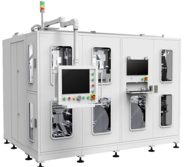
本设备用于实现锂电池负极极片Tab焊接位置的材料去除。清洗效果好，无破损、无起皱、无针孔。
