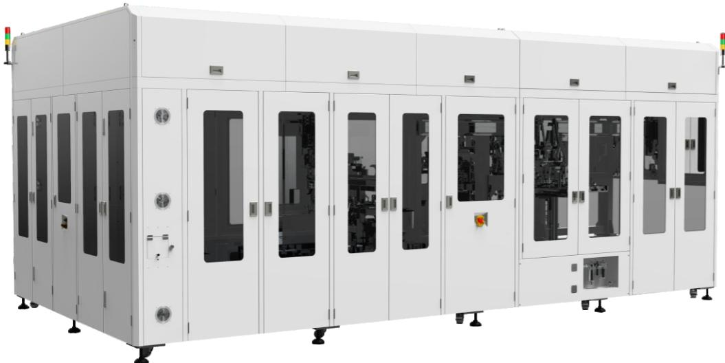
设备用于动力电池的转接片、保护片与电芯装配后进行超声波焊接，通过高频振动将转接片、保护片与电芯极耳紧密融合，从而达到设定导流目的，主要功能包括：电芯扫码、电芯上料定位及极耳整形、转接片上料定位、保护片上料定位、极耳根部预焊、极耳裁切、超声波焊接及除尘、焊印贴胶、电芯下料及排不良。
