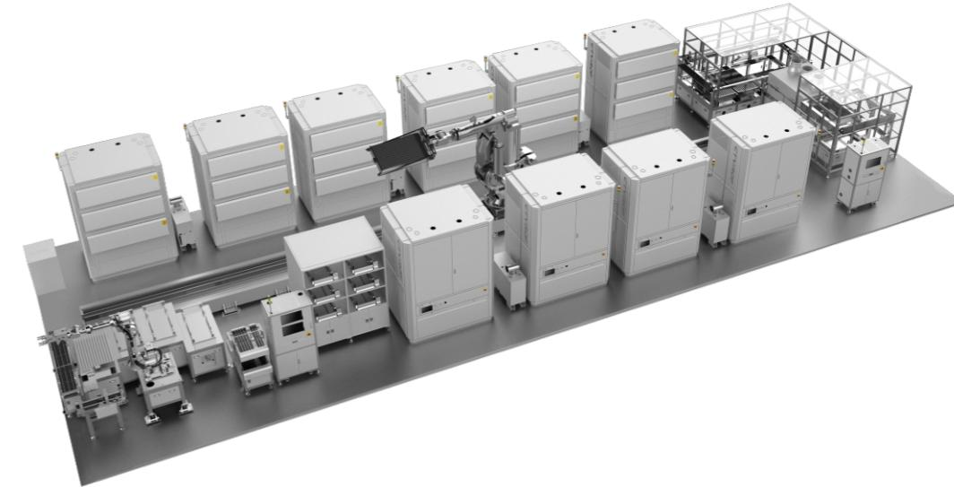
设备用于动力电池的物流调度及烘烤功能，具备工艺流程自动控制，历史数据查询导出，关键参数实时显示，问题报警及原因追溯，安全保护，主要功能包括：电池扫码、上料及缓存、电池烘烤、水含量测试、电池冷却，温度检测及下料。
