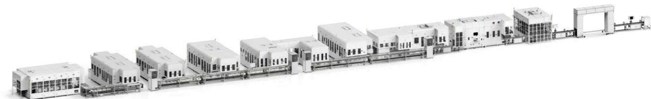
该线用于动力电池中段装配，涵盖当前市面上多种主流工艺，主要设备包括：全自动热压成型机、全自动电芯配对机、全自动超声波焊接机、全自动转接片焊接机、全自动包Mylar机、全自动电芯入壳机、全自动顶盖焊接机、全自动氦检机。
