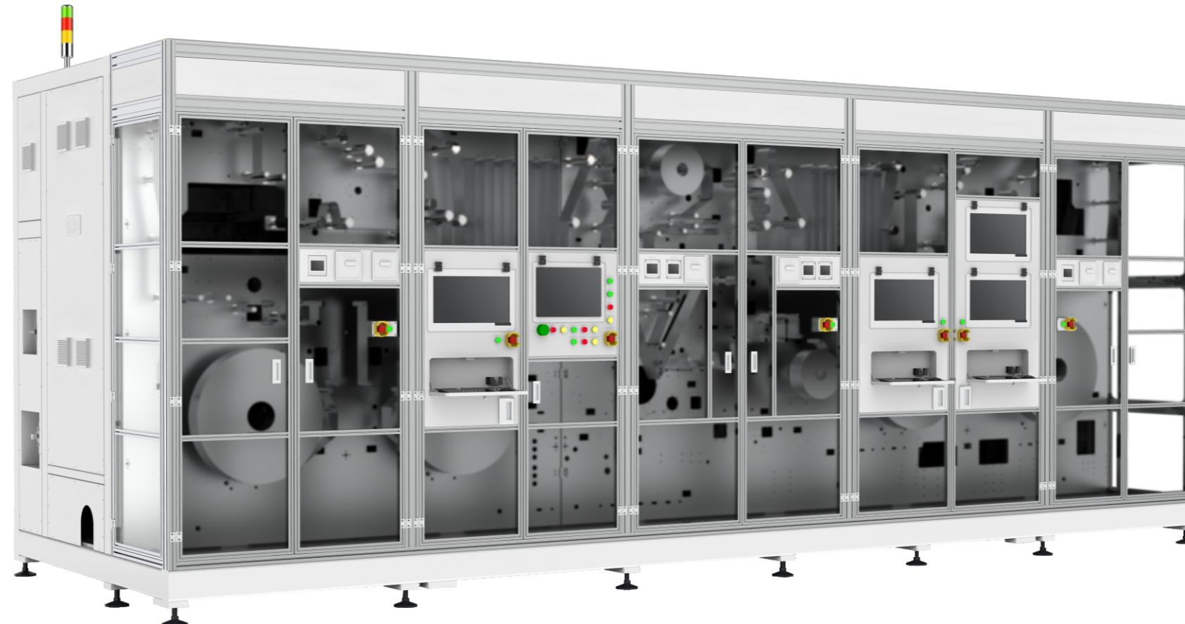
本设备用于实现锂电池正负极极片极耳的制作，以及正负极极片与隔离膜的卷绕装置。
