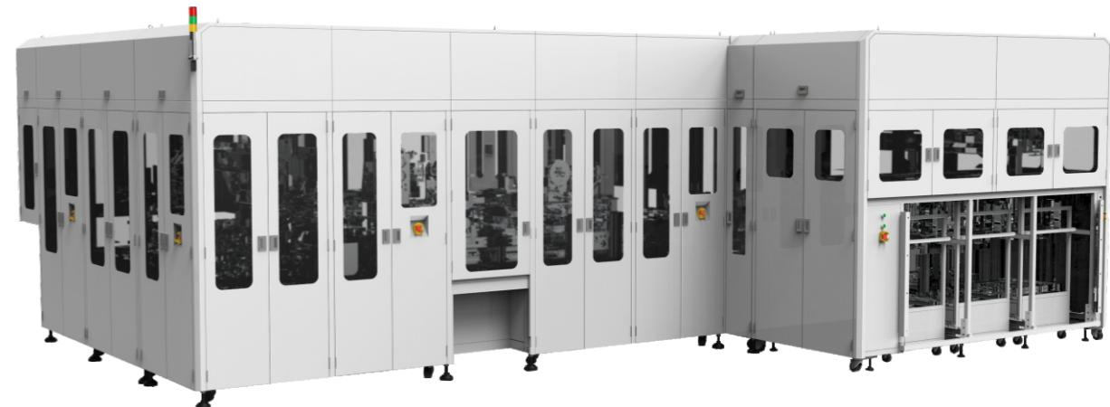
设备用于动力电池的转接片与顶盖装配后进行激光焊接，主要功能包括：顶盖上料定位、顶盖刻码及扫码、电芯上料定位、激光离焦量检测及焊接、焊印除尘、焊印贴胶、合芯整形、合芯捆绑贴胶、下料及排不良。
