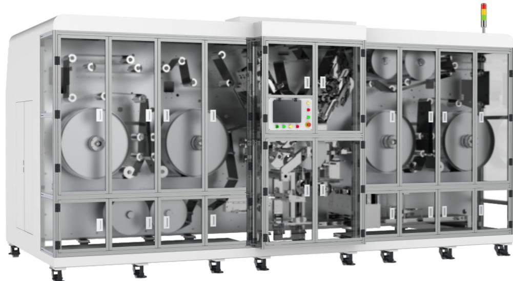
本设备用于锂电池裸电芯制造的制片卷绕工序。
