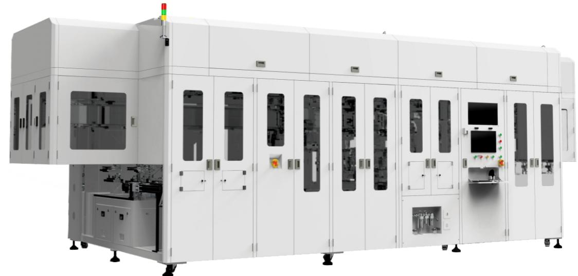
设备用于动力电池的A/B电芯配对，保证A/B电芯铜铝极耳方向一致，主要功能包括：电芯扫码、称重、测厚、极耳错位及方向检测、拔针不良检测、电芯排不良、单电芯缓存、电芯翻转、电芯配对、电芯捆绑贴蓝胶、JR信息绑定上传。
