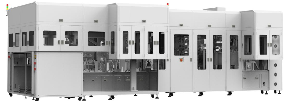
设备用于动力电池的电芯与壳体自动装配，主要功能包括：电芯扫码、电芯上料清洁及定位、壳体上料定位、壳体内部清洁、电芯入壳及压力实时监控、入壳后顶盖四周清洁、Hi-Pot测试、顶盖压装、台阶检测、激光预焊、下料及排不良。
