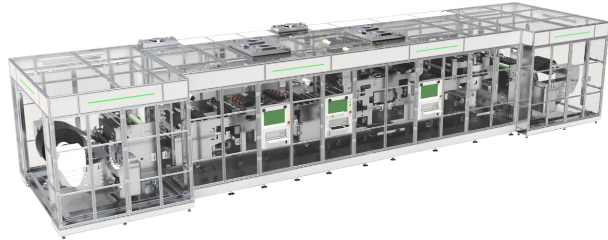
本设备用于实现锂电池负极极片Tab焊接位置的材料去除。清洗效果好，无破损、无起皱、无针孔。
