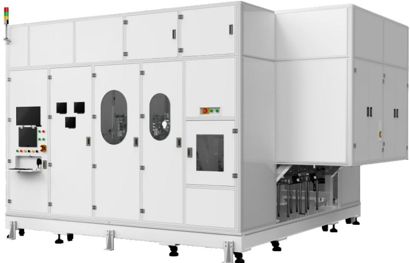
设备用于动力电池的顶盖注液口与铝钉激光焊接，实现电池的全密封性，主要功能包括：电池扫码，电池上料定位，注液口激光清洗、密封钉除尘及自动上料定位，CCD自动寻址、激光离焦量检测及焊接，焊后检测，焊接飞溅物及烟尘吸收处理，电池下料及排不良。
