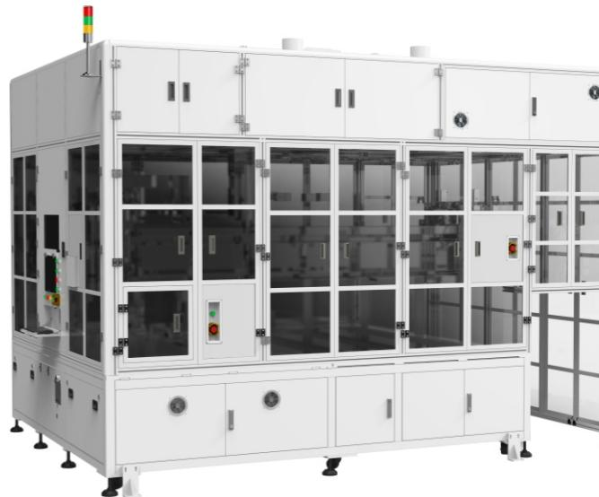
设备用于动力电池顶盖焊接后的密封性测试，主要功能包括：电池扫码、电池上料、氦检、腔体清氦及检测、不良品自动复测、电池下料及排不良。
