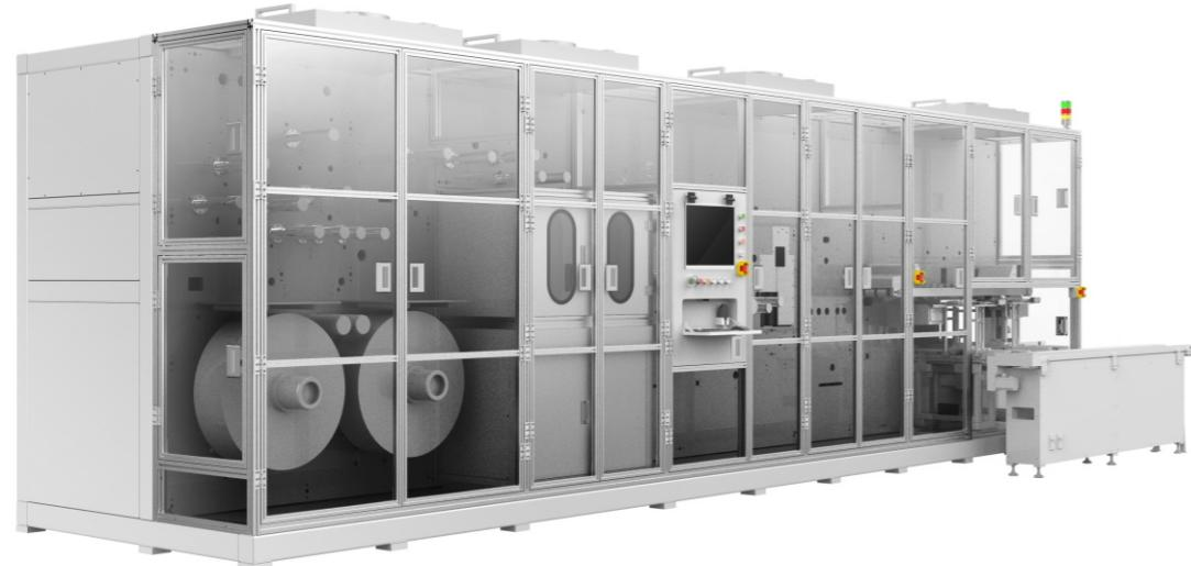
本设备用于实现锂电池正负极片单边极耳成型、V角成型及裁断功能。
