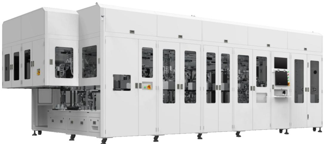
设备用于动力电池的Mylar与电芯装配后熔接在顶支架上，起到保护电芯的作用，主要功能包括：电芯扫码、电芯上料定位、底托片与Mylar上料定位及热熔、电芯包Mylar、热熔焊接、CCD检测、贴胶、下料及排不良。
