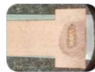
软包电池极耳 Lug laser welding
